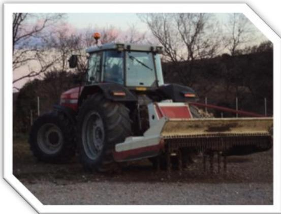
Broyeur à axe vertical double rotor de puissance, 2,60 m en largeur de
